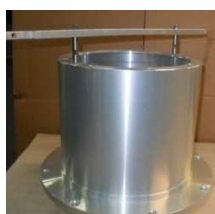
Conversion chimique (Cr3+) : Surtec 650
